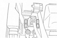
Pod předním sedlem je umístěna jedna náhradní pojistka s hodnotou 30 A.
